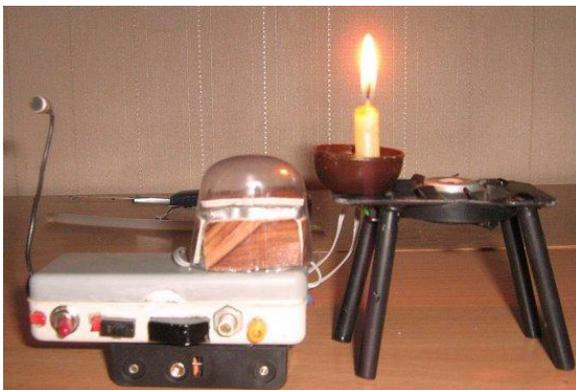
Конструктивное оформление разработки реализовано (см.фото) в виде подсвечника, снабженного горизонтально расположенным миниатюрным бесшумным плоским вентилятором, включение которого осуществляется акустическим реле с регулируемым порогом чувствительности его срабатывания и длительности задержки режима «включено».
