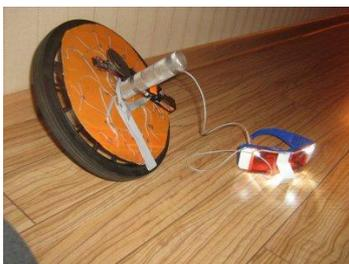
Конструктивное оформление разработки (см.фото) реализовано в виде гимнастического ролика (колеса с двумя ручками), снабженного сенсорами углов поворота его колеса, которые коммутируют генераторы музыкальных
