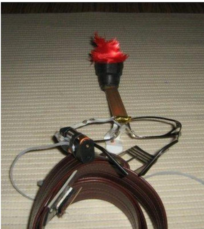
Конструктивное оформление разработки реализовано в виде оправы для очков, на которой закреплен горизонтальный стержень с зафиксированным на его торце миниатюрным имитатором костра. Имитатор выполнен в виде освещаемых светодиодным излучателем лоскутов красной ткани, развеваемых миниатюрным вентилятором, что способствует формированию высокой реалистичности визуального динамического эффекта «горения костра с трепещущими языками пламени» (Чausовский Г., 2012). Включение
