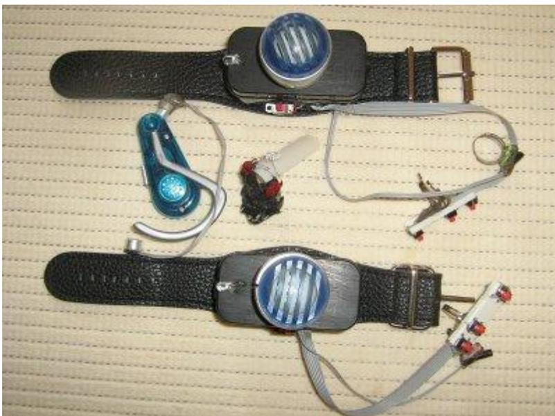
Конструктивное оформление разработки реализовано (см. Фото) в виде двух (для левой и правой руки) браслетов на которых закреплены миниатюрные электронные синтезаторы имитирующие звуки ударников, грохот тарелок, барабанный бой звуков барабана. Включение синтезаторов производится с помощью закрепленных на пальцевом кольце миниатюрных виброударных сенсоров.
