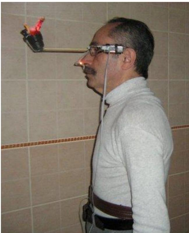
Оправа очков снабжена также наносником с зафиксированным на нем миниатюрным термонагревателем, обеспечивающим синхронизированное с дыханием воздействие на тепловые рецепторы назолабиальной (носогубной) области пользователя. Термонагреватель пропитывается эфирным маслом кедра, которое усиливает эмоциональную (обонятельную) компоненту визуализации динамического эффекта «горения костра», а также характеризуется антистрессовым эффектом.
