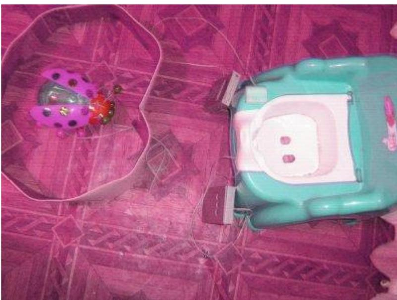
Конструктивное оформление разработки реализовано (см. фото) в виде обычного детского горшка, на наружной поверхности сидения которого закреплен миниатюрный тактильный сенсор, который при усаживании ребенка на горшок включает портативное устройство звукового воспроизведения предварительно сделанной голосом мамы звукозаписи слов поощрения: «Молодец, мой ребеночек!».
