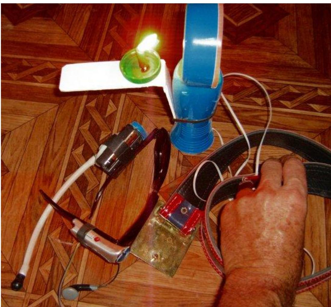
Конструктивное оформление разработки реализовано (см. фото) в виде настольного малогабаритного безлопастного вентилятора, соосно центру кольца которого, через которое формируется воздушный поток, крепится подложка для свечи. Подложка для свечи размещается с тыльной стороны кольца вентилятора – т.е. в зоне, в которой формируется область разрежения, в которую втягивается воздух с дальней от пользователя стороны. Засасываемый с тыльной стороны кольца вентилятора воздух
